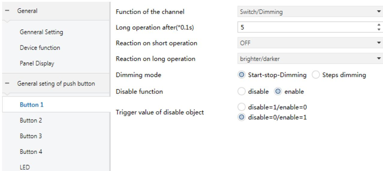
Figure 3.2.3 Parameter window“Button X- Switch/Dimming”
