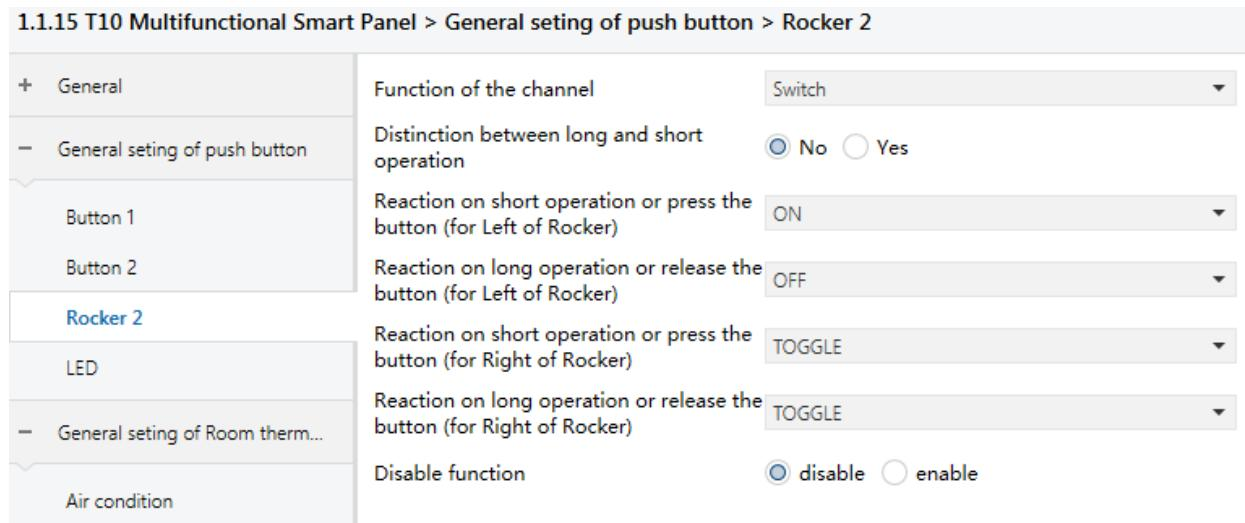
Figure 3.2.11 Parameter window“Rocker X- Switch”
