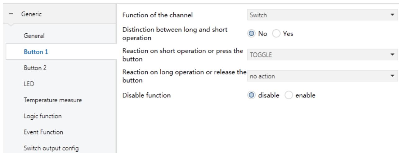
Figure 3.2.2 Parameter window“Button X- Switch”
